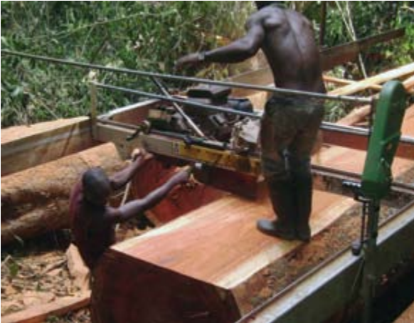
Photo 3 : Débitage à l'aide d'une scie mobile. (Photo Wim Sauwens)
